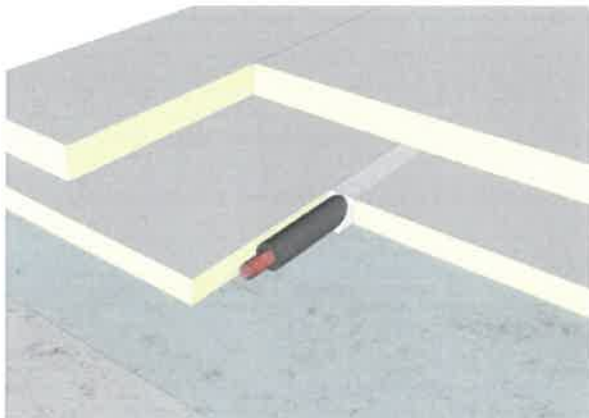
Afbeelding 4 – Tweelaagsinstallatie met leidingen en kabels
